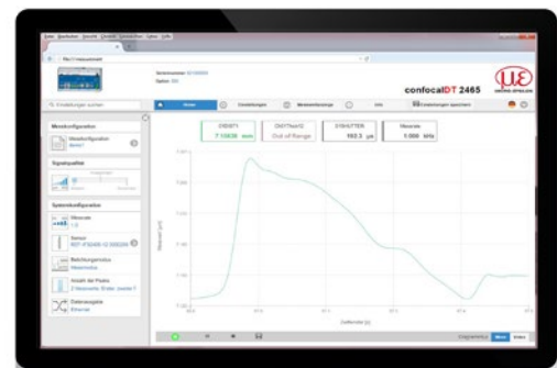
Alle Einstellungen werden über das Webinterface vorgenommen. Für die Dickenmessung ist eine Materialdatenbank hinterlegt, die beliebig erweitert werden kann.
