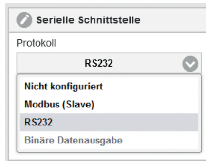
Abb. 73 Ansicht Serielle Schnittstelle CFO250 - RS232
