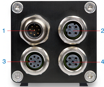
Abb. 10 Buchsenanordnung am colorSENSOR CFO200
