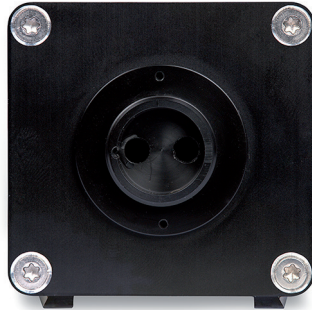
Abb. 18 Sensoranschluss am Controller
