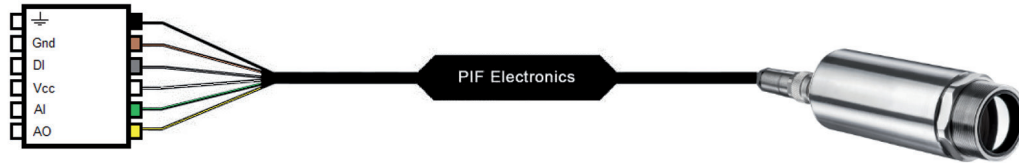
Abb. 15 Anschlussplan Klemmleiste thermoIMAGER TIM 40
