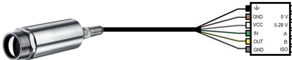
Abb. 14 Anschlussplan Klemmleiste thermoMETER TIM 8 / thermoIMAGER TIM 41
