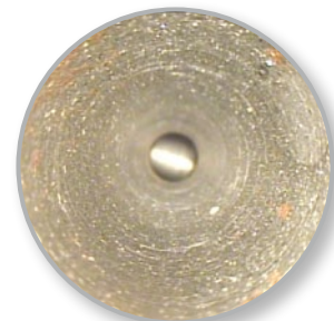
Ablagerungen im Rohr
