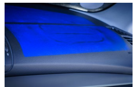
Vollflächige Rückprojektion des Inspektionsergebnisses
