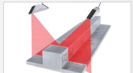
Geometrieprüfung in der Metallbearbeitung
