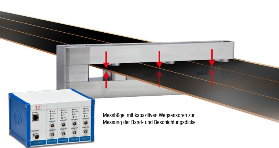
Bei der zweiseitigen Dickenmessung erfassen kapazitive Sensoren die Banddicke mit hoher Genauigkeit. Aufgrund ihrer hohen Temperaturstabilität ist der Einsatz auch in heißen Umgebungen möglich.
