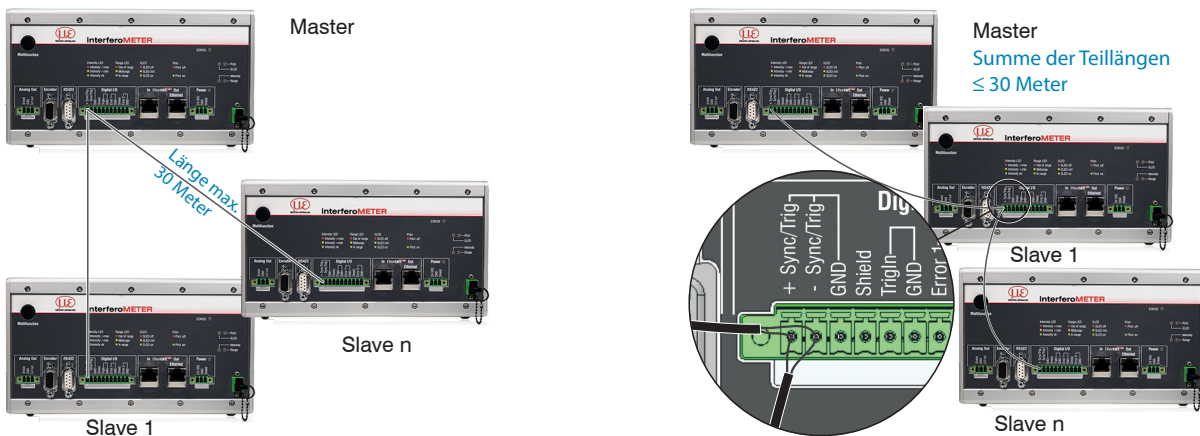
Abb. 19 Synchronisierung mehrerer Controller, links sternförmig, rechts verkettet
