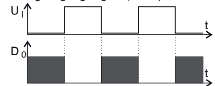
Abb. 36 Triggerpegel High (oben) und Analogausgangssignal (unten)
