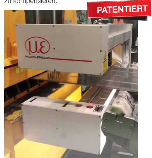
Zusätzliche Messung der Breite, sowie der Säbeligkeit mit patentierter Kompensation toleranzinduzierter Effekte
