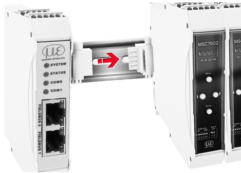
Abb. 6 Anschluss einer MSC7602 mit MSC7602-Steckersatz
