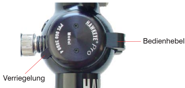
Abb. 12 Steuerung der Sondenspitze durch Bedienhebel
