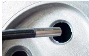
Abb. 13 Einführen der flexiblen Sonde in einen Hohlraum
