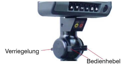
Abb. 3 Bedienelemente über dem Handgriff
