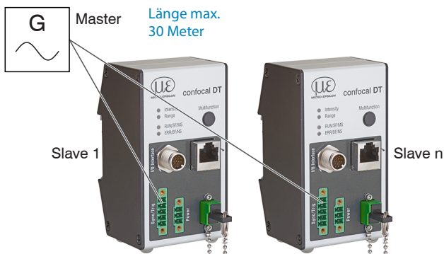
Abb. 29 Synchronisierung mehrerer Controller, sternförmig
