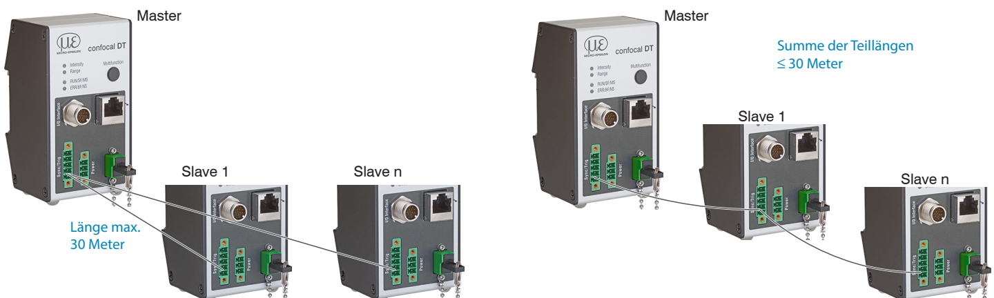
Abb. 27 Synchronisierung mehrerer Controller, links sternförmig, rechts verkettet
