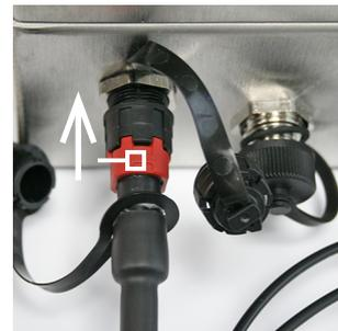
Abb. 30 Anschluss Sensorkabel am Controller IMC5420IP67-TH
