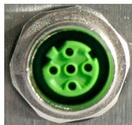
Abb. 28 Buchse für Ethernet
