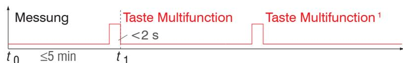
Abb. 63 Ablaufdiagramm für Nullsetzen, Mastern (Multifunction-Taste)
