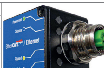
Abb. 6 LEDs an der Ethernet/ EtherCAT-Buchse
