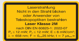
Abb. 2 Laserhinweisschild und Laserwarnschild LLT30xx-200
