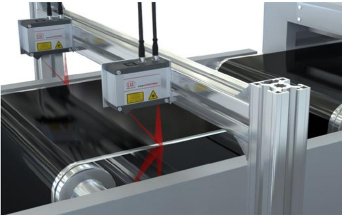
Breite, Dicke und Heavy Edge an Batteriefolien
